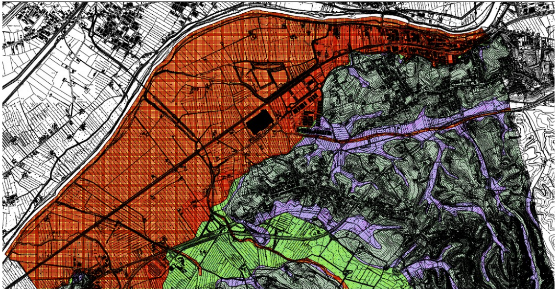
Corografia della pericolosità idraulica – zona Nord
